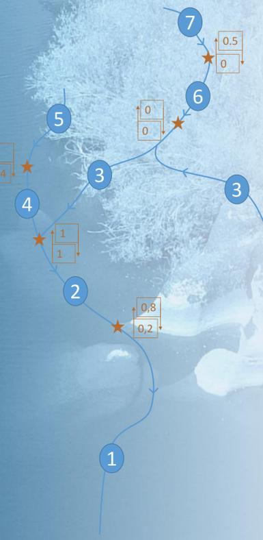
Grafo fluvial simplificado, en el que los tramos de un río (nodos) se identifican con números enteros (círculos azules) y los obstáculos (enlaces o vértices) son las estrellas rojas y se identifican por los tramos que conectan (a su lado, en marrón, figura la probabilidad de franqueo en ascenso y descenso)
